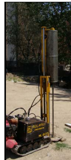
■ SONDEIGS DPSH : Emplaçament dels sondeigs DPSH-1, DPSH-2 i DPSH-3.
